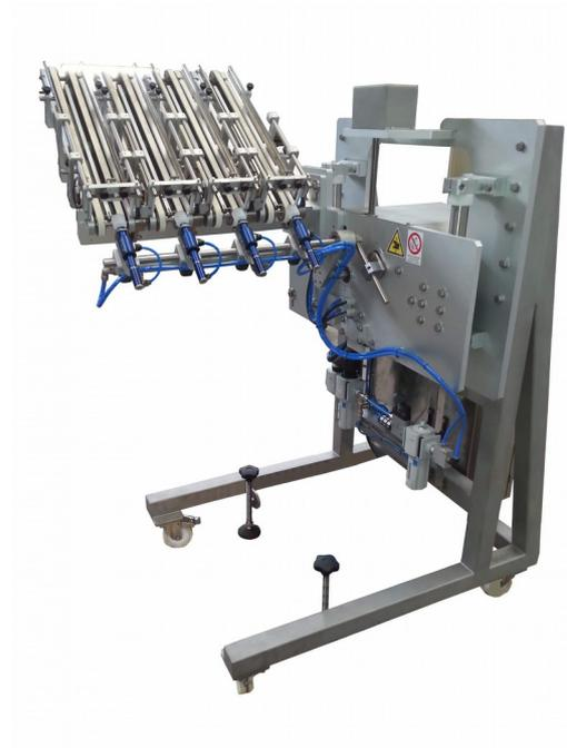
La macchina disimpilatrice a ventose (DMF) è stata progettata per poter disporre prodotti o contenitori con precisione sopra ad un nastro trasportatore. Può funzionare con vaschette, pirottini, fette di pane o pan di spagna.
